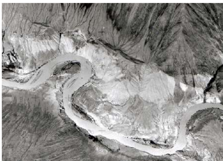
Рисунок 4. Молодые разрывы на правом борту долины р. Нарын в зоне Северного разлома, примерно в 11 км выше по течению от Карабашского ущелья. Разлом, проходящий в основании высокого склона, отделяет палеозойские отложения висячего крыла от неогенового лежачего крыла.
