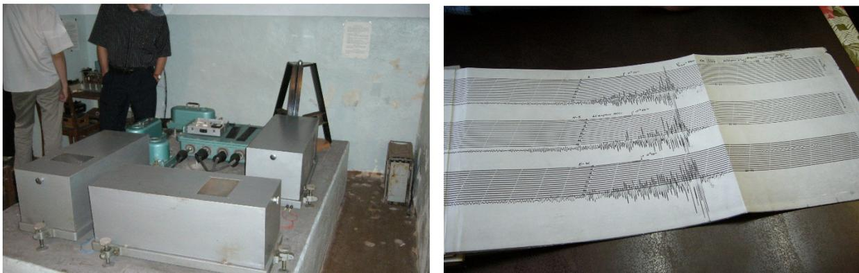
**Рисунок 4.** Сейсмограф Кирноса СКМ-3 с увеличением 20000 и пример полученной сейсмограммы.
