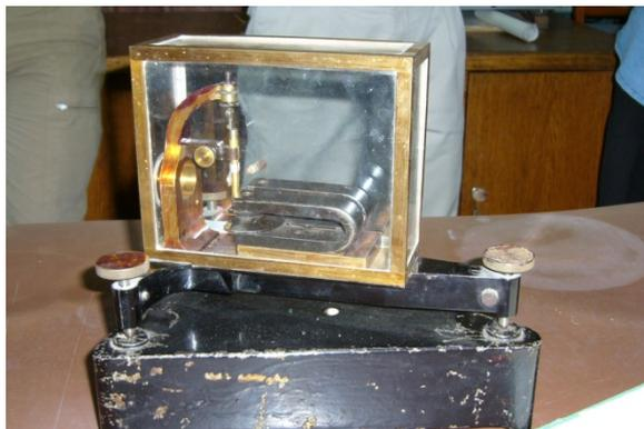
**Рисунок 2.** Сейсмограф с прямой оптической регистрацией, разработанный П.М. Никифоровым, установленный на станции «Фрунзе» ИС НАН КР (1927 – 1950 гг., NS, EW компоненты).
