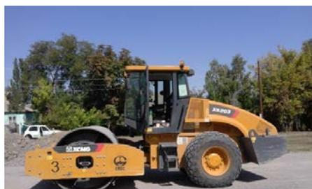
Рис.2. Строительный каток.
