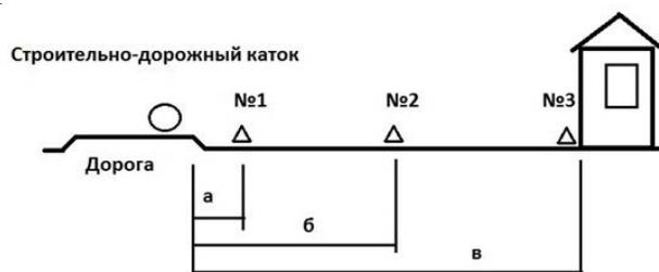
Рис.1. Расположение точек и их номера: а – расстояние от дороги до точки № 1; б – расстояние от дороги до точки № 2; в – расстояние от дороги до точки №3.
