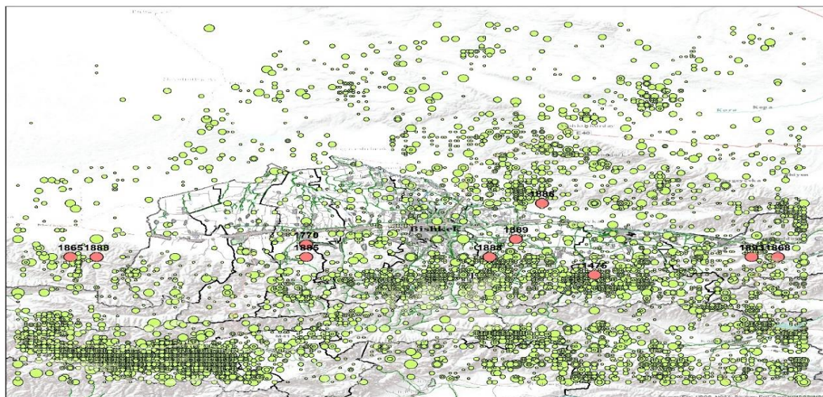
Рисунок 3. Карта очагов землетрясений на территории Чуйской впадины с 1474 г. по 2021 г. Большие кружочки – очаги разрушительных землетрясений [1].
