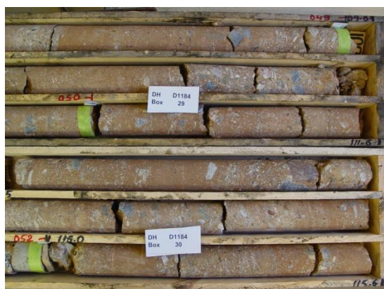
Рисунок 4. Керновый материал скважин, пробуренных на площади Кумтор.
