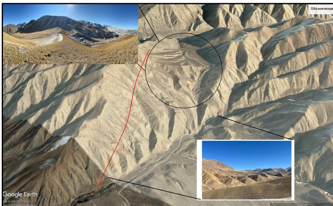
Рисунок 4. Положение разломной структуры относительно проектируемых объектов ЗИФ и хвостохранилища. Красной линией показано предполагаемое положение разлома. Участок, выделенный окружностью, представлен на фотографии в левом верхнем углу. В пределах данной зоны располагаются площадки проектируемых объектов золотоизвлекательной фабрики (ЗИФ) и хвостохранилища. На фотографии в правом нижнем углу показаны элементы структурно-тектонического строения района (см. также рисунок 2).
